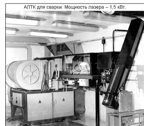
АЛТК для сварки. Мощность лазера — 1,5 кВт.
