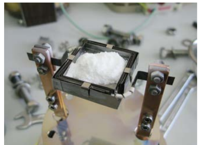
Тигель, в который помещен порошкообразный сцинтиллятор CsI(Tl). Тигель нагревается и сцинтиллятор испаряется
