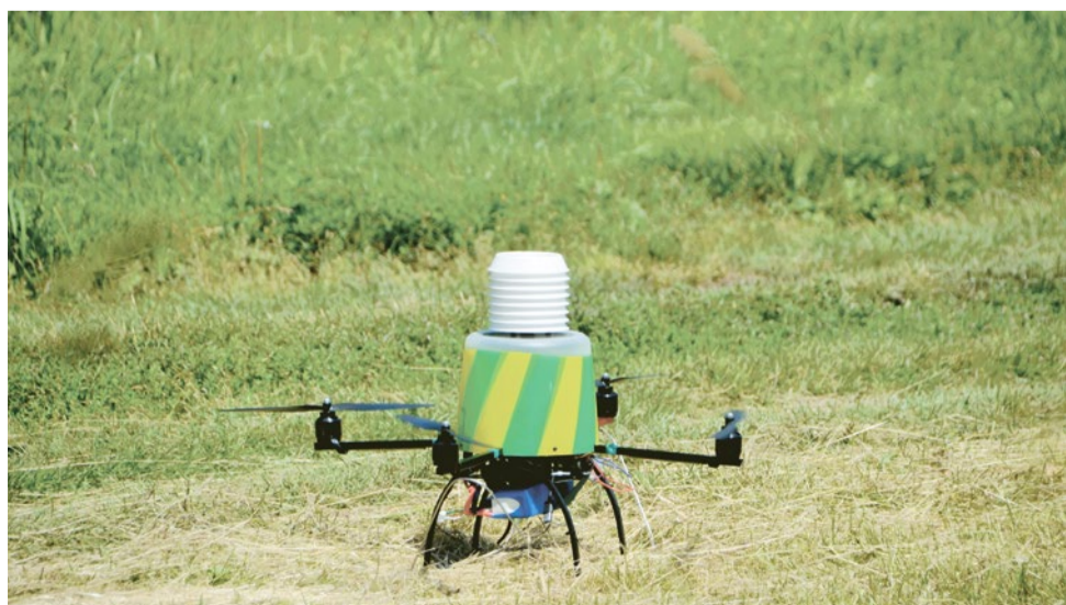
Портативная автоматическая электронная метеостанция, установленная на беспилотнике. Аппарат готов к полету
