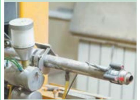
Импульсный газодетонационный аппарат
