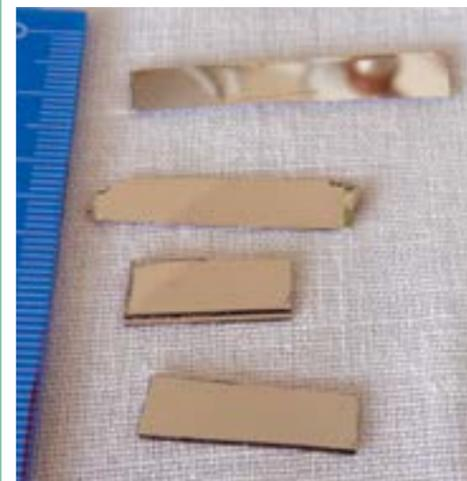
Кристаллы топологического изолятора Bi<sub>2</sub>Se<sub>3</sub>
