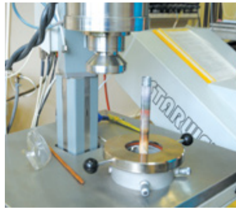
Ячейка с металлом на держателе, которая помещается в печь установки
