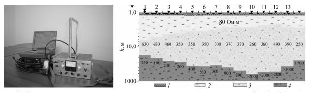
**Рис. 10.** Комплект аппаратуры для радиоимпедансного зондирования слоистой среды в диапазоне 10— $300 \, к$ Гц (слева) и геоэлектрический разрез по профилю реки Селенга в районе переправы «Тресково», март  $2004 \, \Gamma$ . Расстояние между пикетами  $20 \, \mathrm{M}$ , между берегом и крайними пикетами —  $15 \, \mathrm{M}$ . I — лед, 2 — вода, 3 — песчано-гравийные отложения, 4 — гравийно-галечные отложения.
