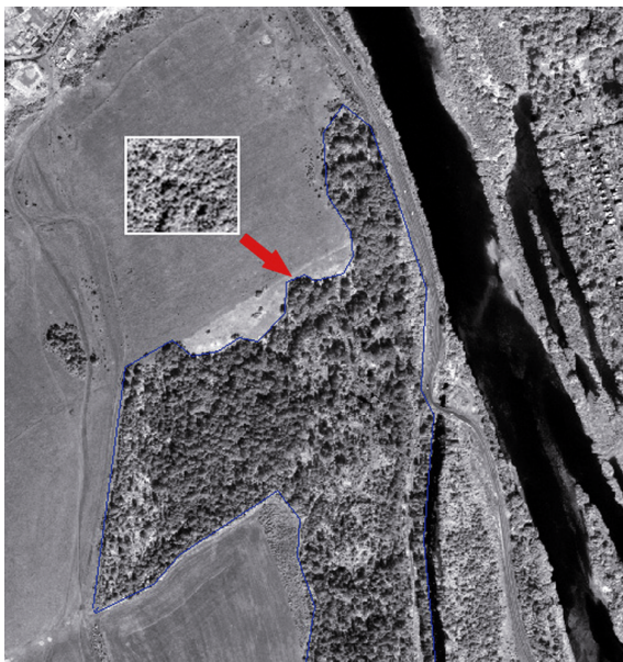
Рис. 23. Результат выделения полигона на снимке QuickBird по образцу с заданной текстурой (образец текстуры показан в левом верхнем углу).
