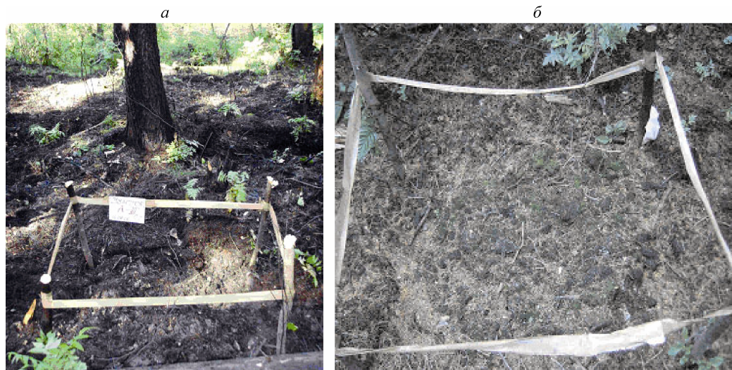
Рис. 25. Загрязненная нефтью почва на участке заложения опытной деляны (снимок 16.08.2007 г.) (а) и этот же участок в процессе рекультивации (снимок 07.07.2007 г.) (б). Остаточное нефтесодержание в почве — 0,6 %. Появились новые проростки мха.
