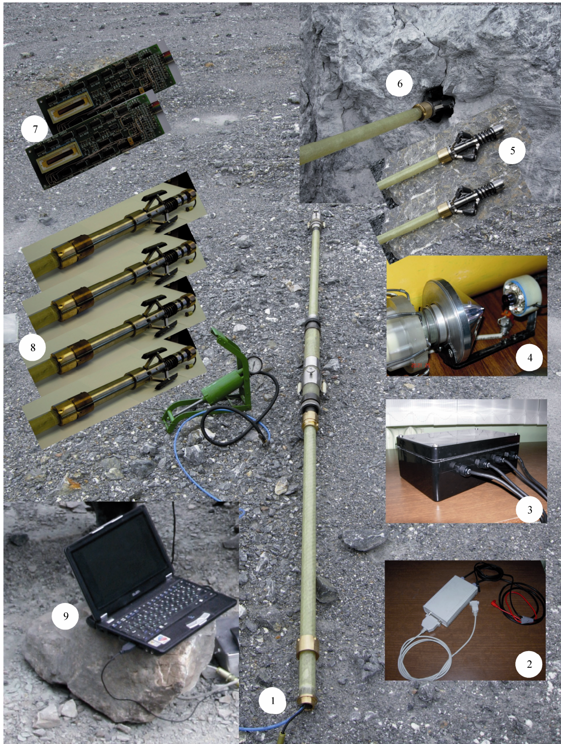
Рис. 31. Многоканальный приборный комплекс для контроля деформаций борта карьера.
