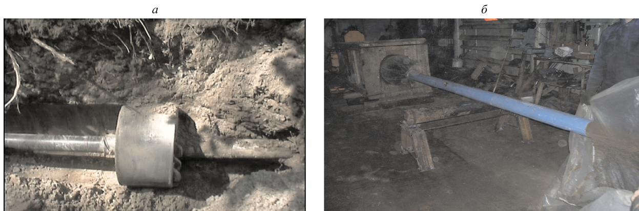
Рис. 36. Общий вид рабочего органа (а) и процесс выноса транспортируемого материала из трубопровода (б).
