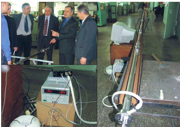
Рис. 18. Многоканальный приборный комплекс для контроля и регистрации деформаций пород в горном массиве через скважину. Разработка ИГД и КТИ НП СО РАН.
