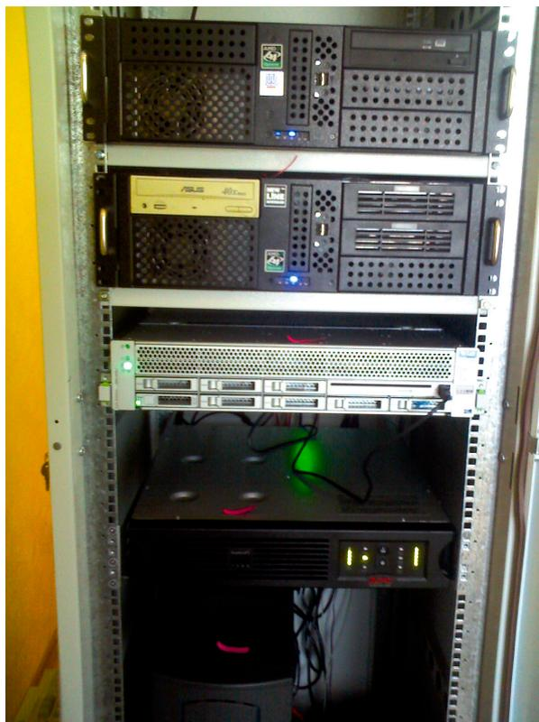
**Рис. 8.** Четырехпроцессорные компьютеры ТНЦ СО РАН на площадке ИФПМ СО РАН на базе двухъядерных и четырехъядерных процессоров AMD Opteron и SunFire X4450.
