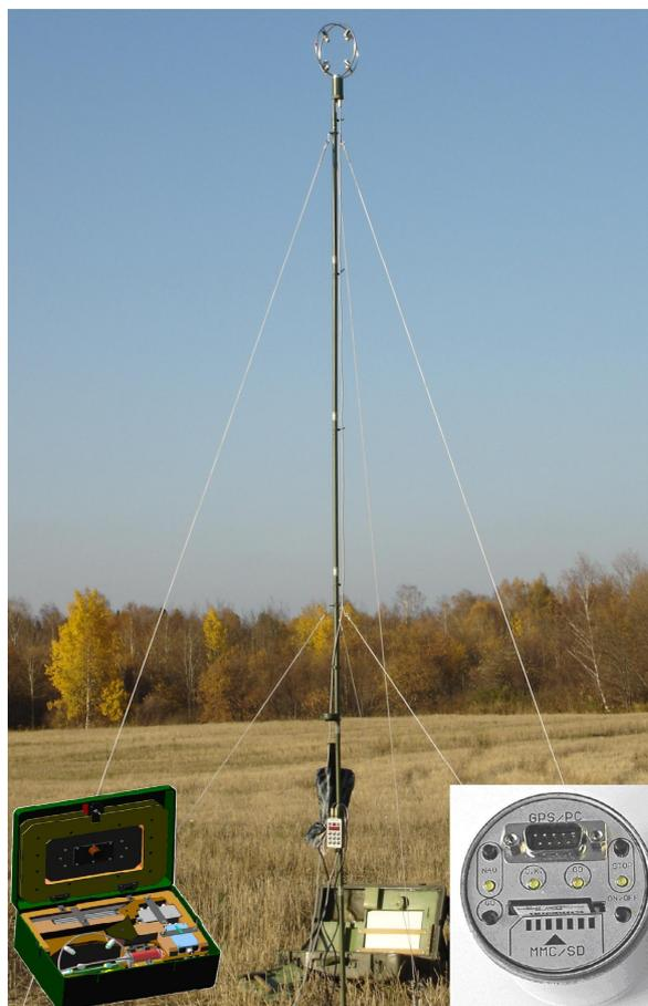
**Рис. 49.** Экспедиционный вариант ультразвуковой метеостанции «Эксметео-01».
