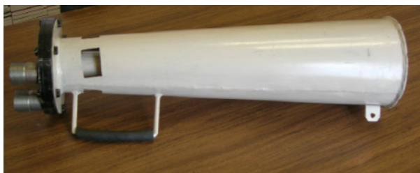
Рис. 6. Эжектор ЭПДМ производительностью 22 м 3 /мин.
