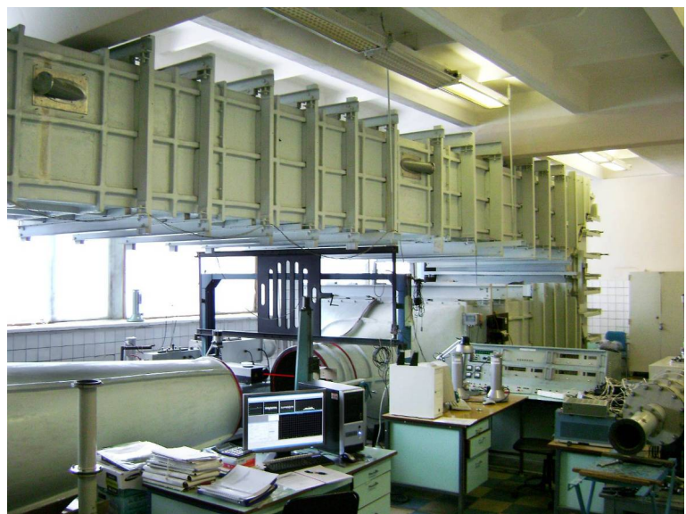
Рис. 16. Государственный специальный эталон единицы скорости воздушного потока ГЭТ-150-85, оснащенный лазерным доплеровским диагностическим комплексом «ЛАД-015».
