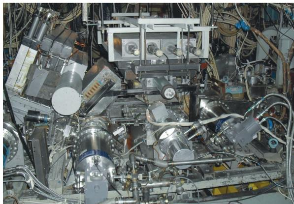
**Рис. 49.** Аппаратура эксперимента по упругому рассеянию электронов и позитронов на протоне: детекторы частиц и внутренняя газовая мишень, установленные на накопителе ВЭПП-3.
