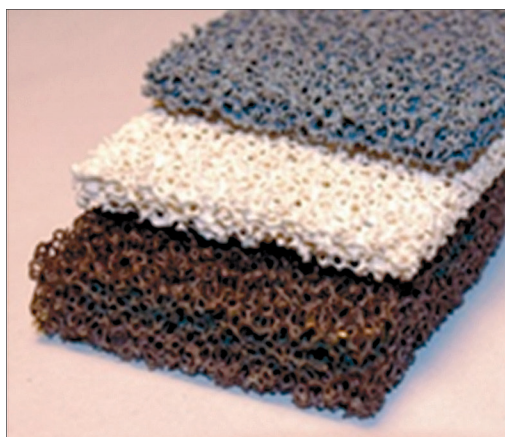
Рис. 18. Пеноматериалы низкой плотности (сплав Ni–Al, корунд, композит SiC/Al–Si–O, рисунок слева) и характеристики топливного элемента (справа) на анодной подложке пеносплав NiO/Zr–Y–O/Ni–Al с тонким слоем электролита Zr–Y–O и нанокompозитным катодом \text{LaFe}_{0,7}\text{Ni}_{0,3}\text{O}_3/\text{La}_{0,8}\text{Sr}_{0,2}\text{Fe}_{0,7}\text{Ni}_{0,3}\text{O}_3 . Кривые, проходящие через максимум, соответствуют мощности элемента при данной температуре (шкала справа); спадающие кривые – вольт-амперные характеристики (шкала слева).
