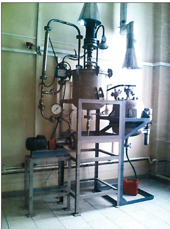
**Рис. 36.** Пилотная установка с роторно-пульсационным аппаратом для исследования процесса диспергирования целлюлозосодержащего сырья.
