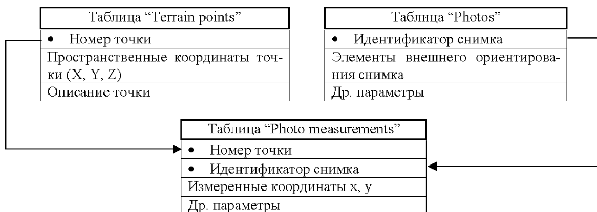
Рис.4: Реляционная модель данных для хранения измерений.
