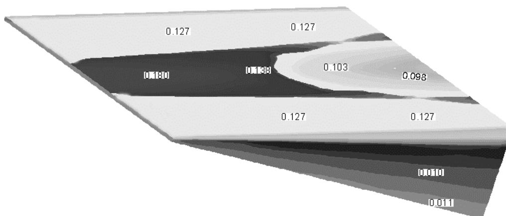
Рис. 4. Распределение давления  $\left(p/\rho_{\infty}W_{\infty}^2\right)$  по поверхности клина  $M_{\infty} = 8.0$  (при наличии электронного пучка).
